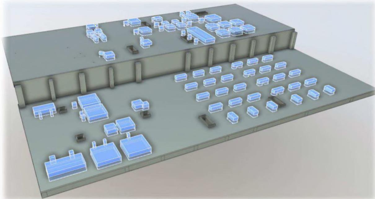
Рисунок А.4 – Подсистема «Фундаменты оборудования» системы «Фундамент»
