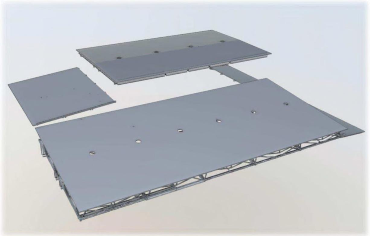
Рисунок А.10 – Подсистема «Конструкции плоской крыши» системы «Система крыши»
