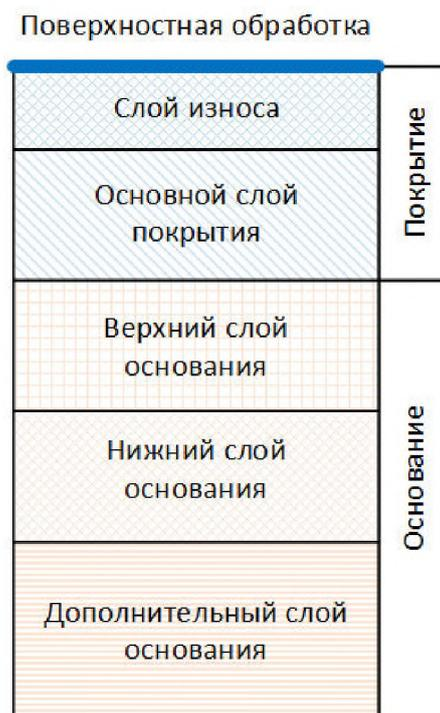
Рисунок 4.1.1.4 – Пример состава конструктивных слоев дорожной одежды
