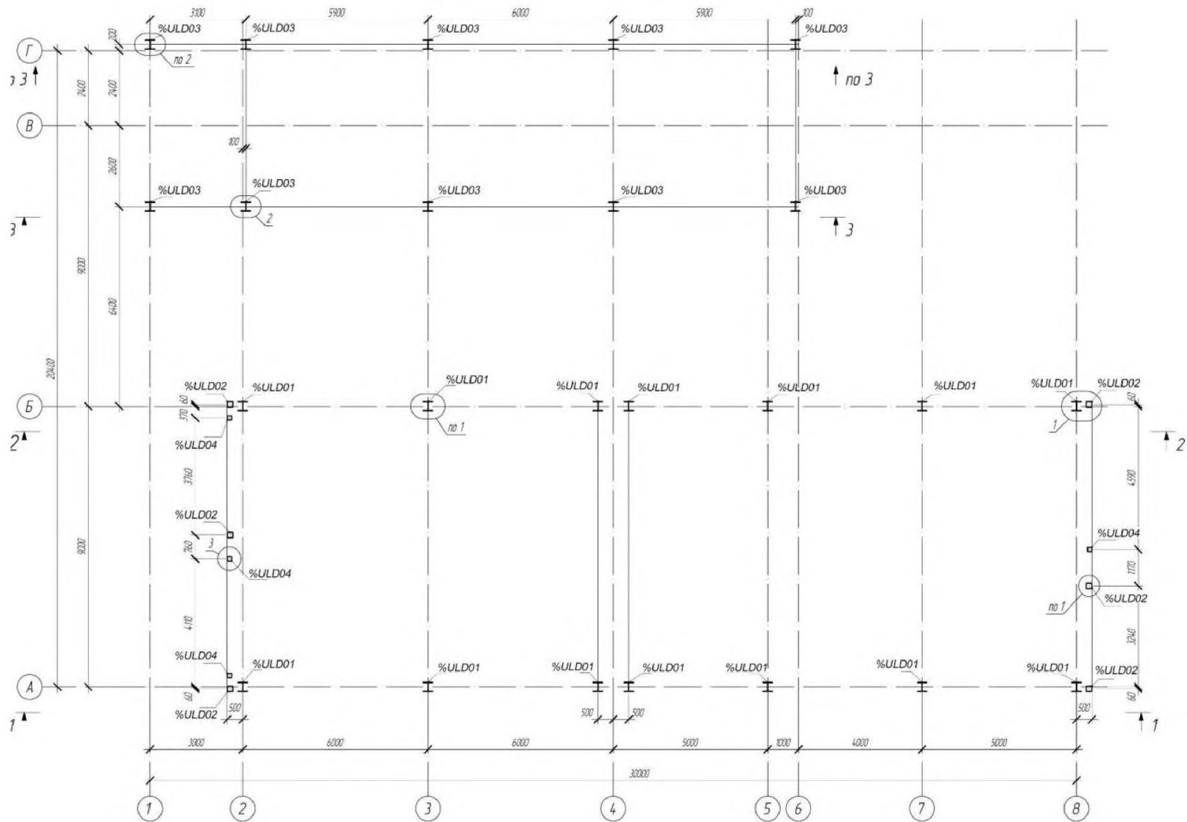
Рисунок Б.5.2 – Обозначение элементов несущего каркаса ЛОС на разрезе
