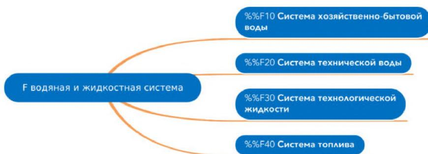
Рисунок 4.3.5.3 – Декомпозиция класса F КТ «Функциональные системы» за счет использования аспекта типа по КСИ (%%)
