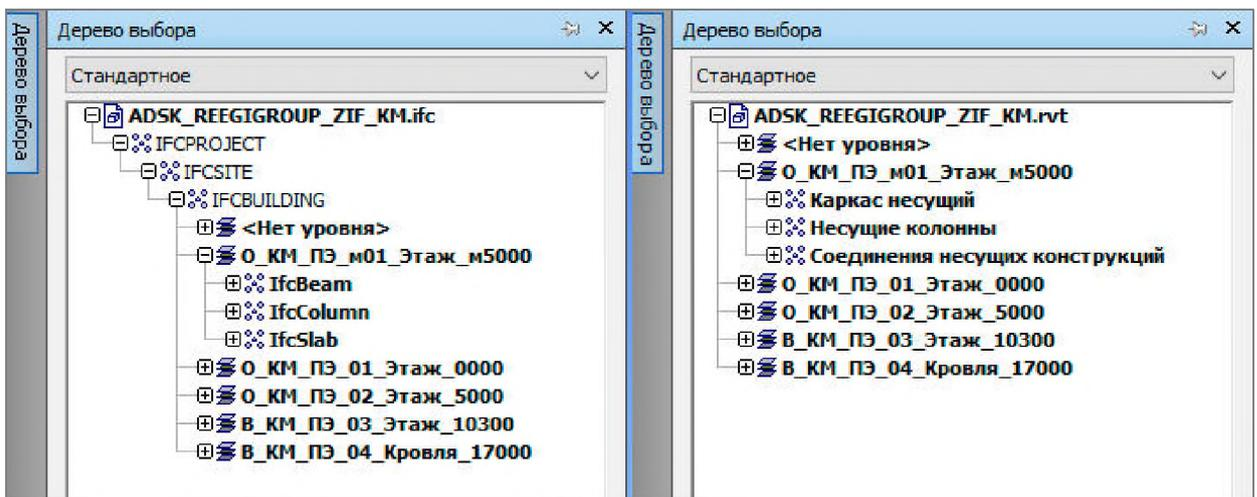
Рисунок 4.1.3.1 – Структуры представления<sup>17</sup> данных для форматов *IFC* (слева) и *rvt* (справа)
