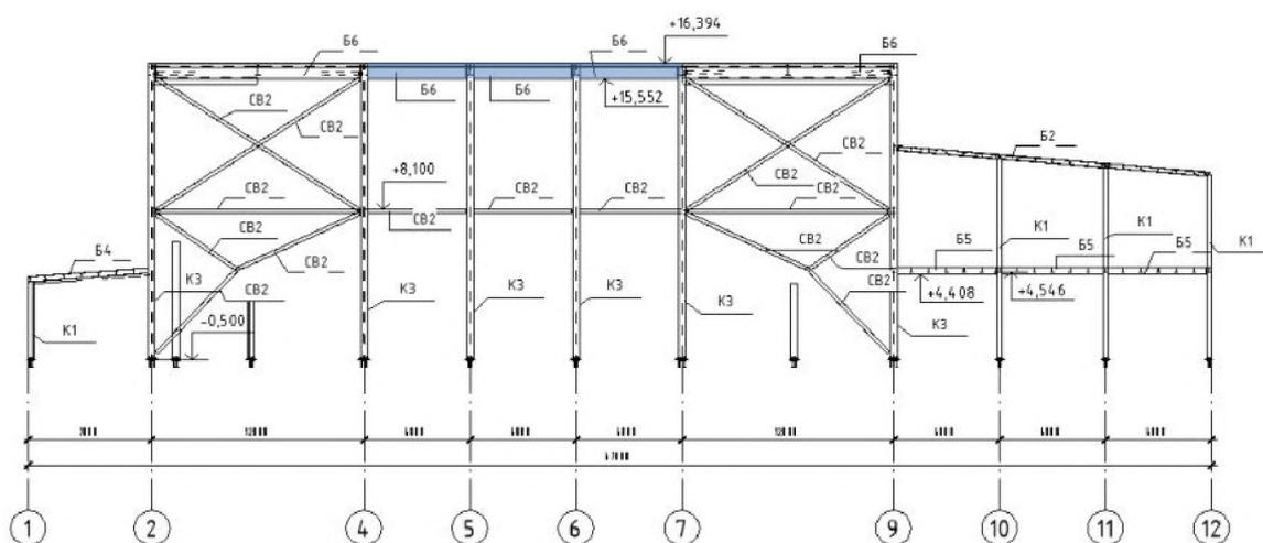
Рисунок В.3.2 – Несущая балка на разрезе
