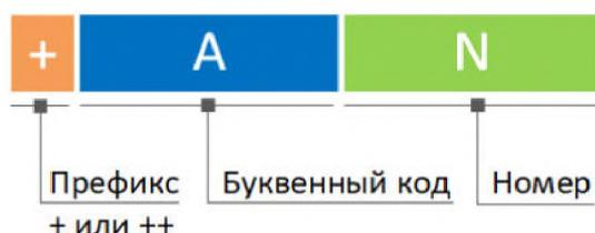
Рисунок 6.4.1 – Схема формирования одноуровневого кодового обозначения аспекта местоположения
