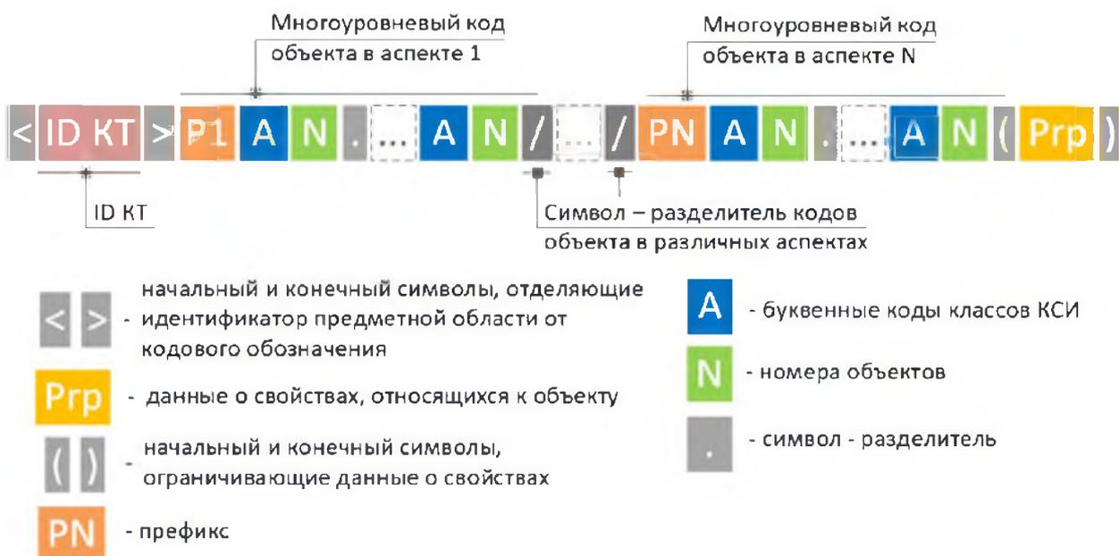
Рисунок 6.8.1 – Схема формирования полного составного кода объекта
