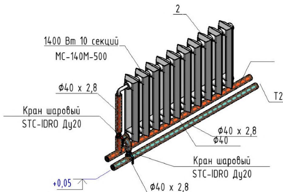
Рисунок В.1.1 – Радиатор как элемент «Рециркуляционной системы снабжения теплом»
