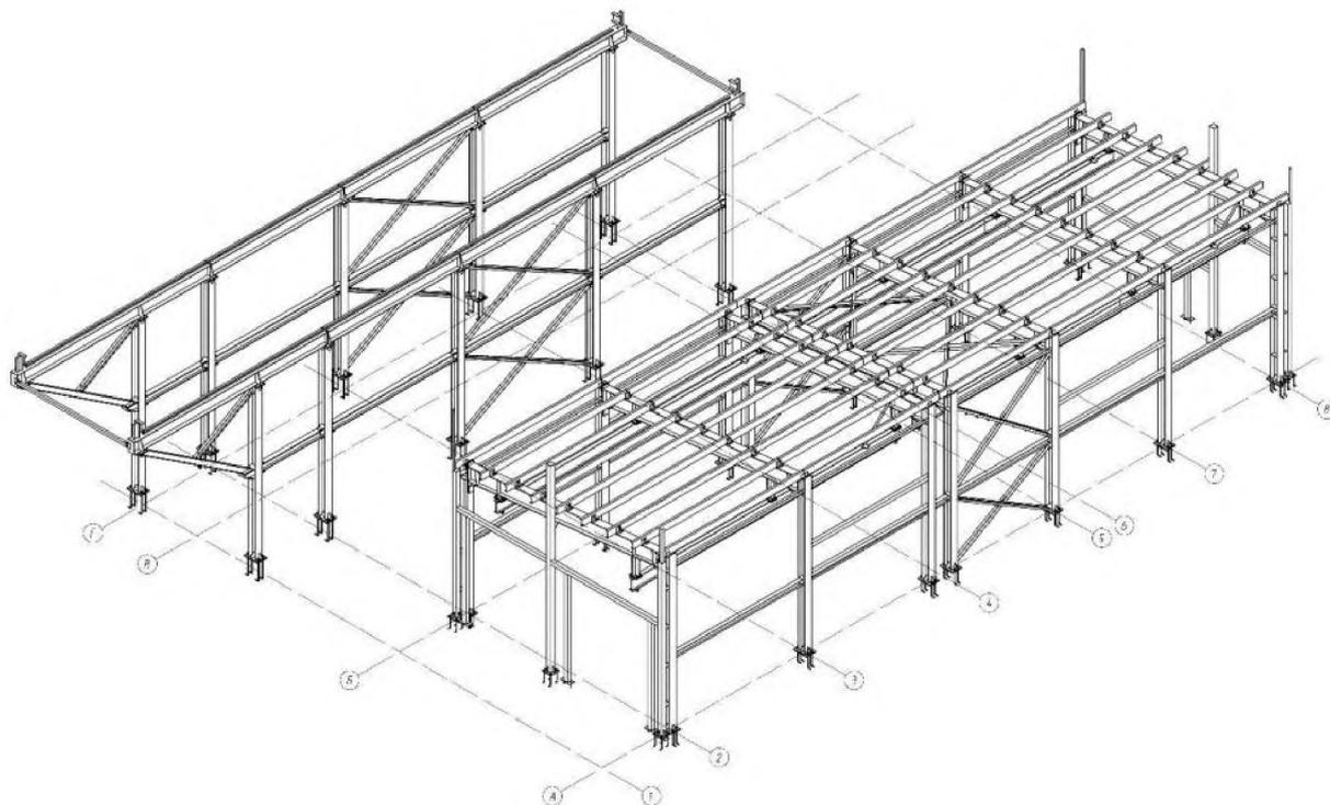
Рисунок Б.5.1 – 3d вид несущего каркаса (ЛОС)
