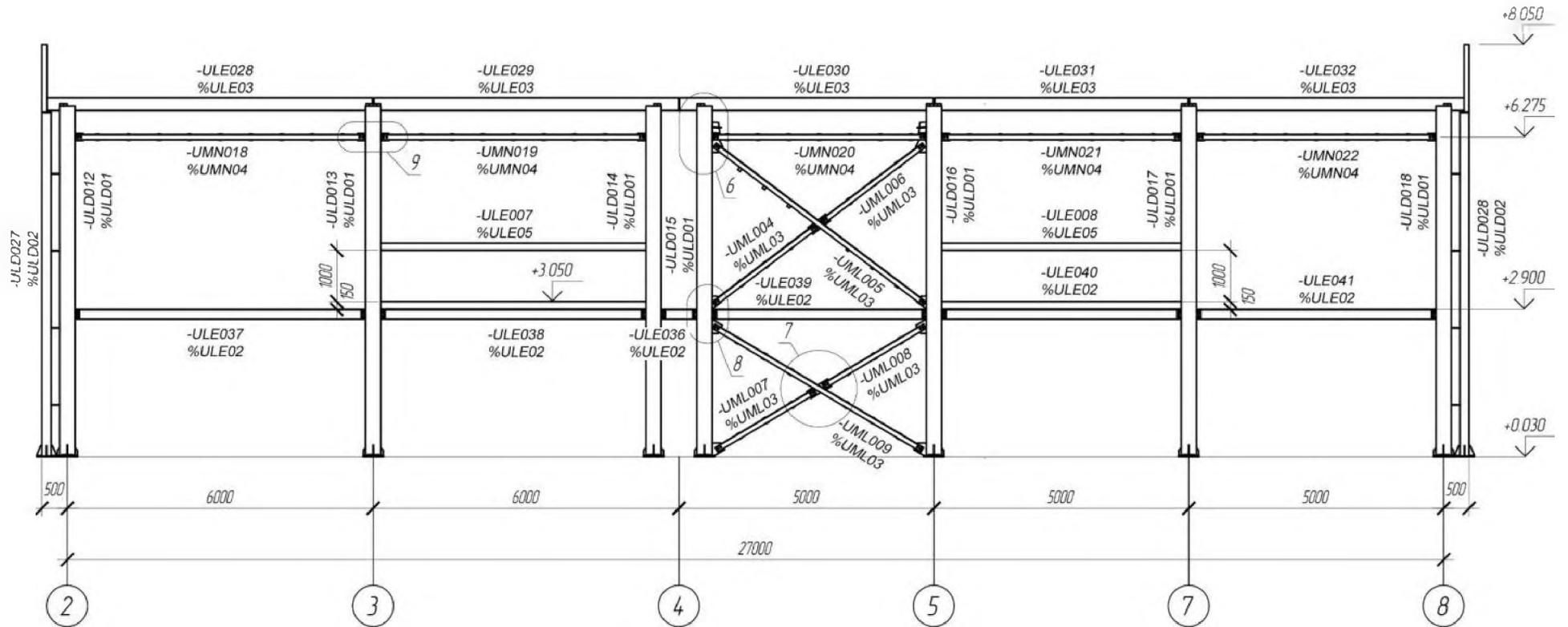
Рисунок Б.5.3 – Обозначение элементов несущего каркаса ЛЮС на разрезе 1-1 (см. рисунок Б.5.2)
