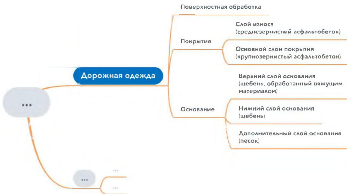
Рисунок 4.1.1.5 – Пример системного представления объекта «дорожная одежда» в качестве подсистемы объекта «автомобильная дорога»
