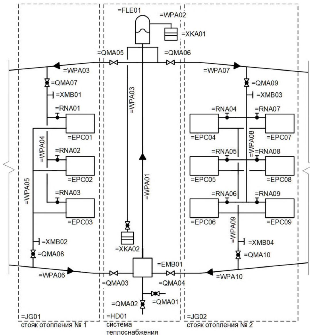
Рисунок Б.1.1 – Схема системы отопления административного здания
