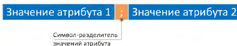
Рисунок 4.2.12 – Схема формирования перечислений в значениях атрибутов элементов
