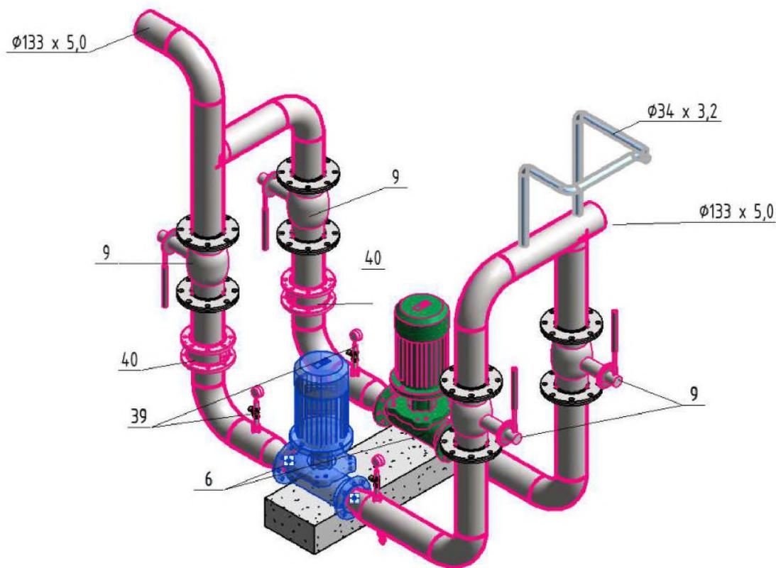
Рисунок В.2.1 – Циркуляционный насос (выделен синим цветом)
