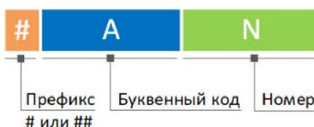
Рисунок 6.6.1 – Схема формирования одноуровневого кодового обозначения пользовательского аспекта
