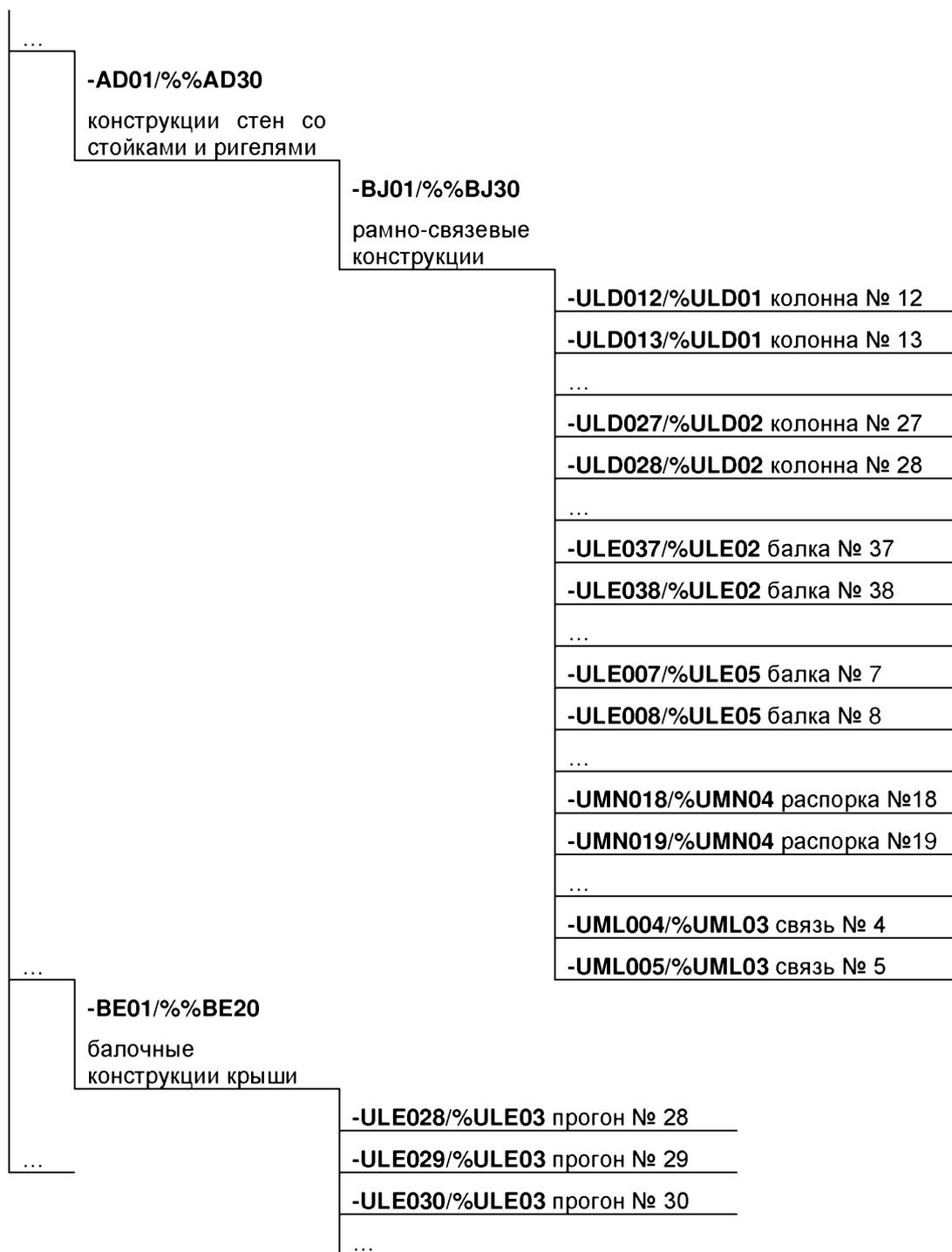
Рисунок Б.5.4 – Фрагмент схемы несущего каркаса ЛОС (см. рисунок Б.5.3)
