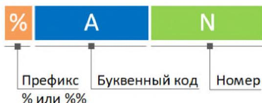
Рисунок 6.5.1 – Схема формирования одноуровневого кодового обозначения аспекта типа
