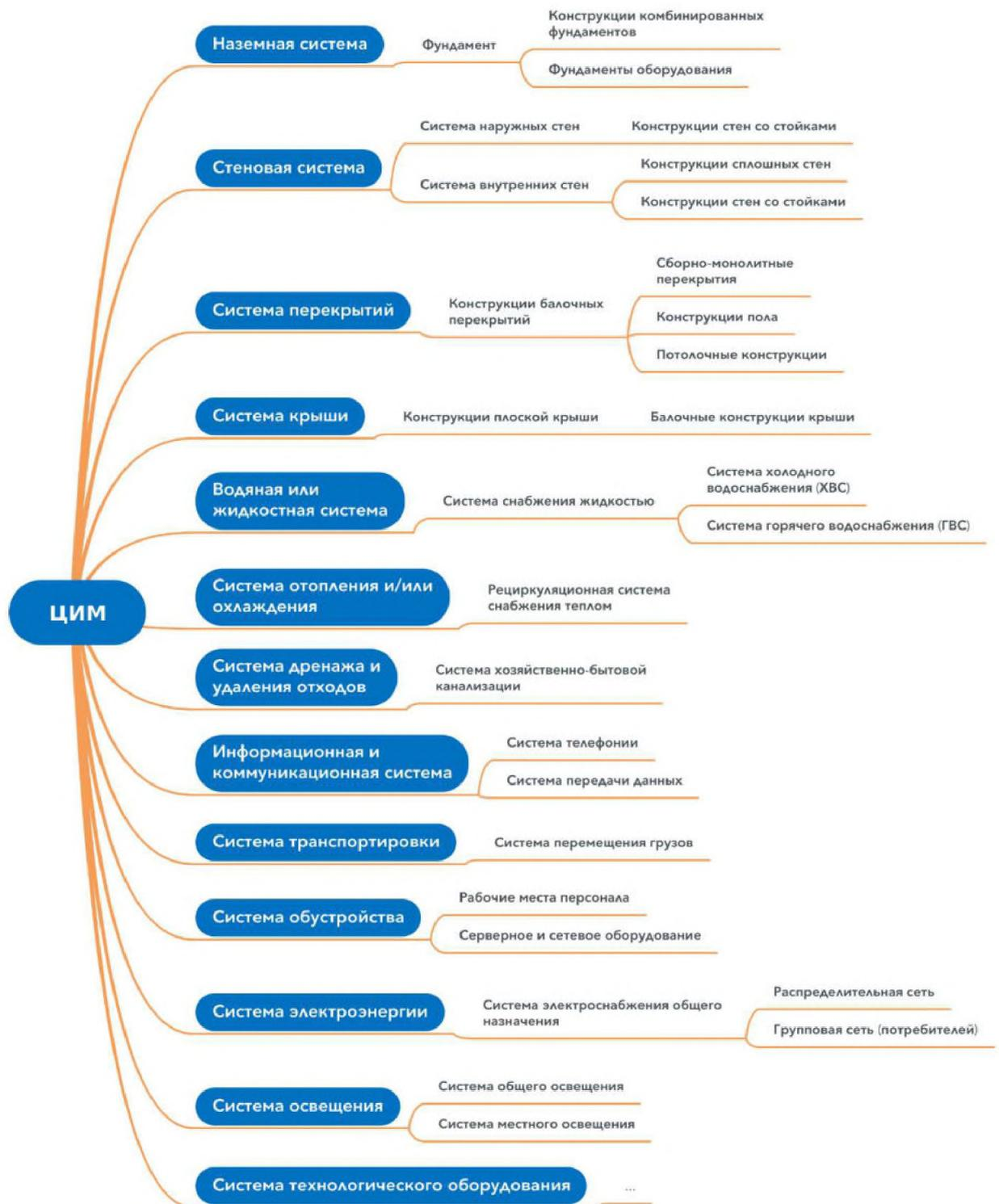
Рисунок 4.1.3.4 – Декомпозиция тестовой ЦИМ на отдельные системы
