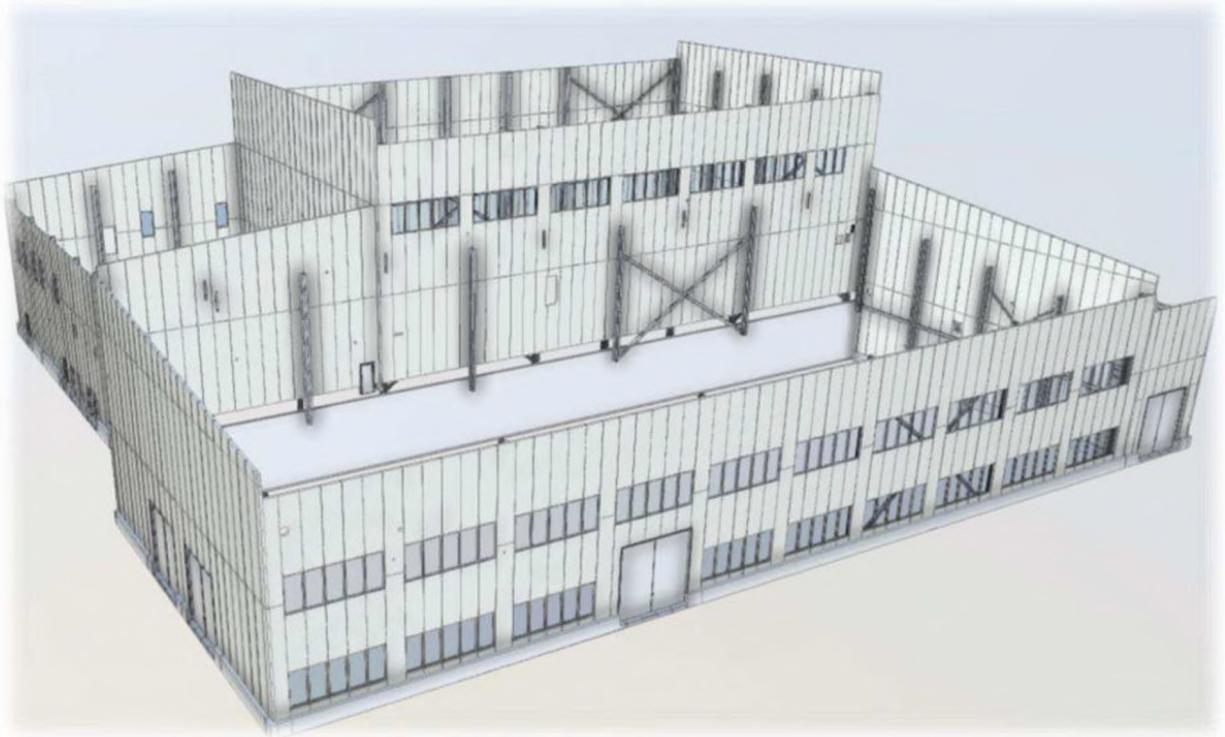
Рисунок А.6 – Система «Система наружных стен»
